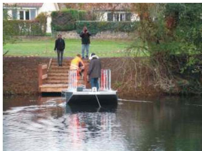
Le principe est simple : il suffit de tirer sur une chaîne pour rapprocher le bac de la rive.
